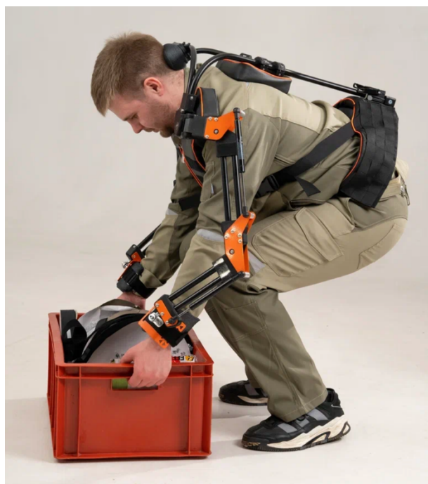
Рисунок 6 – Принцип работы с грузом в экзоскелете
