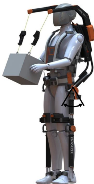
Рисунок 3 – Диапазон вращения бедренного шарнира при ходьбе
