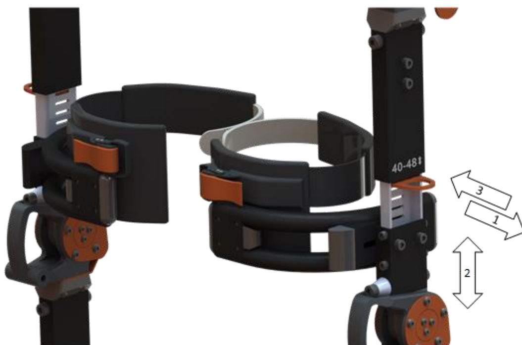
Рисунок 9 – Регулировка длины звена бедра
