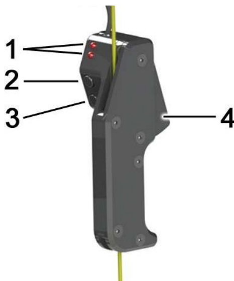
Рисунок 4 – Пульт управления модулем подъема груза: 1 – светодиодная индикация текущего режима работы модуля подъема груза: верхний светодиод – индикация режима «подъем», нижний светодиод – индикация режима «спуск», 2 – кнопка режима «подъем», 3 – кнопка режима «спуск», 4 – кнопка фиксации пульта управления на тросе
