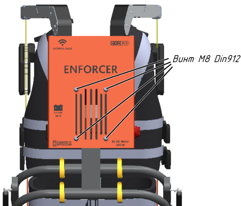
Рисунок 12 – Схема регулировки для изменения высоты положения модуля подъема груза
