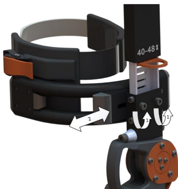
Рисунок 10 – Схема регулировки вылета бедренной манжеты
