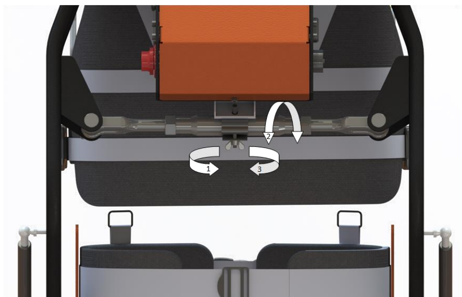
Рисунок 11 – Регулировочная двойная стяжка для изменения ширины таза экзоскелета
